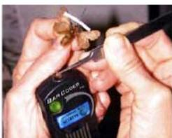
Fig. 2 - Protótipo de aparelho portátil para identificação de espécies usando código de barras de DNA (Adapt. de Stoeckle, M., Waggoner, P. E. & Ausubel, J. H., 2004)
