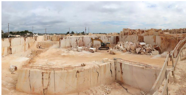
Foto 26 – Proteções nas frentes de desmonte, pedreira de rocha ornamental
