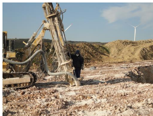
Foto 44 – Furação para carregamento da pega de fogo em pedreira para produção de britas
