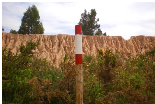
Foto 37 – Estaca identificadora de um vértice da poligonal da área da pedreira
