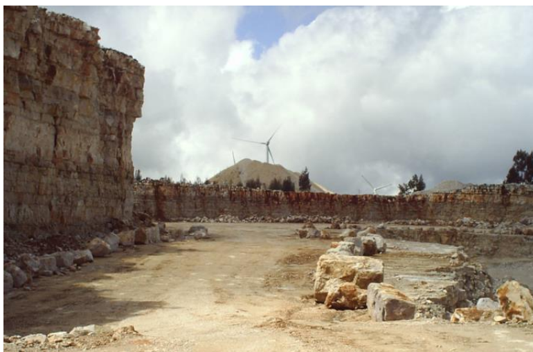
Foto 29 – Blocos como barreira física de proteção
