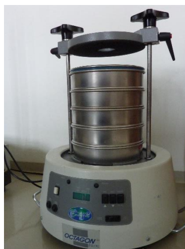
Figura 5 – Exemplo de crivos de arame com diferentes aberturas e série de peneiros em agitador mecânico.
