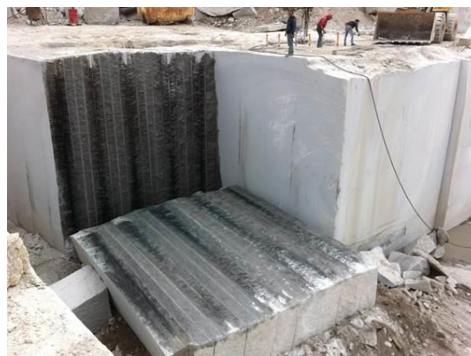
Foto 34 - Pedreira de granito ornamental, desmonte de uma talhada, Aguiar da Beira
