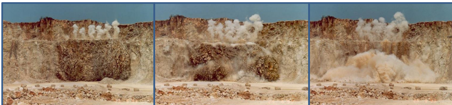
Foto 45 – Sequência do rebentamento de uma pega de fogo.
