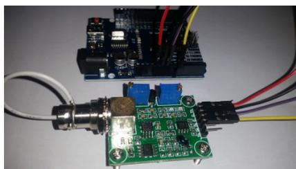
FIGURA 1 Montagem com Arduino e sensor de pH.
